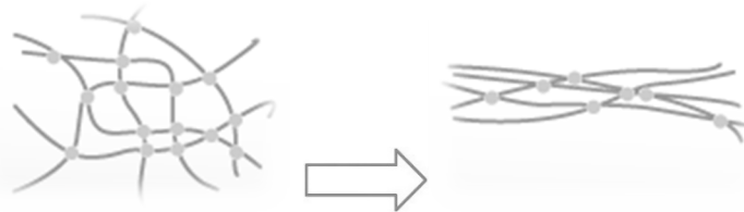
ภาพที่ 6 การจัดเรียงตัวของโมเลกุลตามทิศ Orientation Process ไปสู่แนวแรง Orientation Direction
